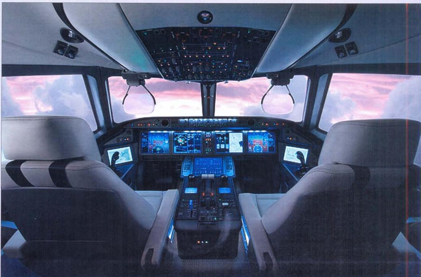
Макет кабины ближнесреднемагистрального пассажирского самолёта МС-21 (магистральный самолёт XXI века) с оборудованием УКБП
