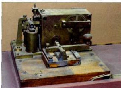
Телеграфный аппарат системы Морзе. Начало XX века
