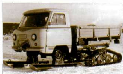
Экспериментальная модель снегохода. Разработка П. Музыюкина
